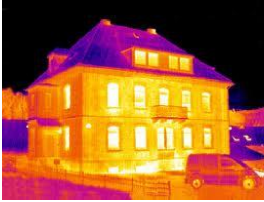
Bir binanın dış yüzeyinin termal görüntüsü
